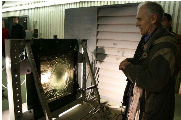
(Photo SMic/NATO) Експерти з Інституту монокристалів у Харкові відіграють ключову роль у створенні нової композиції для легкого та прозорого армованого скла, яке використовуватиметься на військових автомашинах та автомашинах безпекового персоналу.
