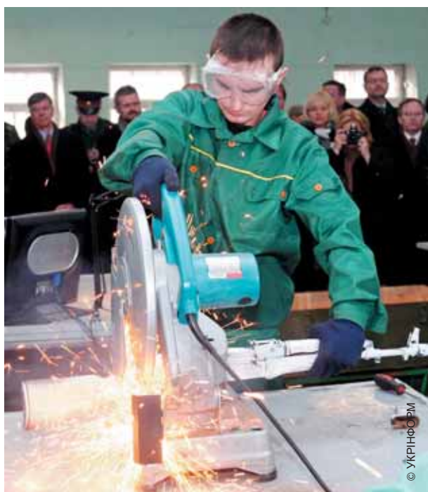
Технічний працівник проводить демонтаж штурмової гвинтівки у рамках робіт з проекту Трастового фонду програми «Партнерство заради миру» в Хмельницькому районі в Україні.
