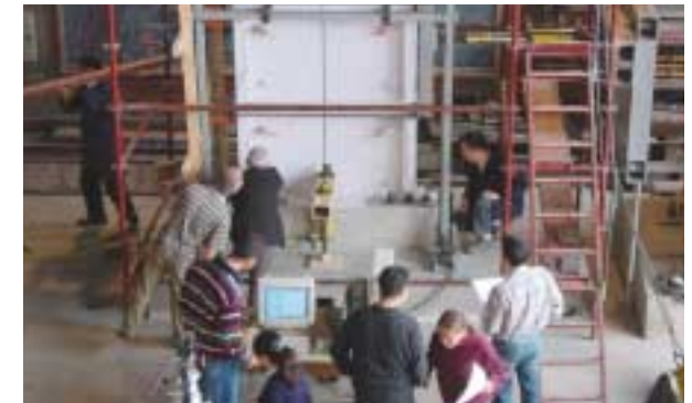
Expérience de projet OTAN : contrôle des effets d'un séisme sur des murs renforcés
